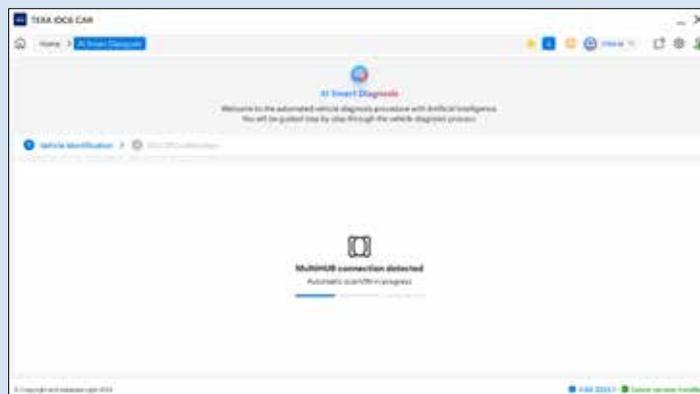
Após o lançamento da funcionalidade, é feita uma conexão com a interface de diagnóstico, que faz a varredura do veículo.
